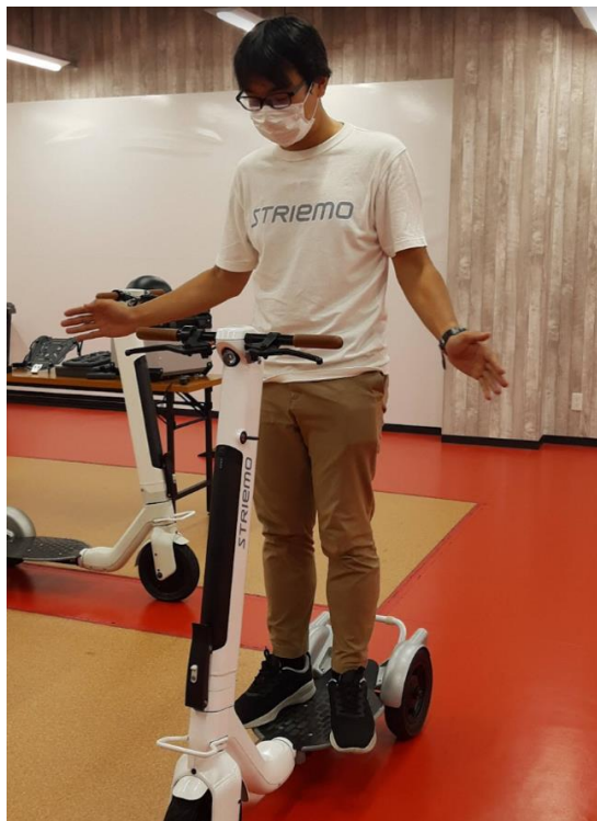
ストリーモは世界初の「バランスアシストシステム」により、停止時も自立が可能。 「安心感」を第一とした新たな移動体験を提供する
