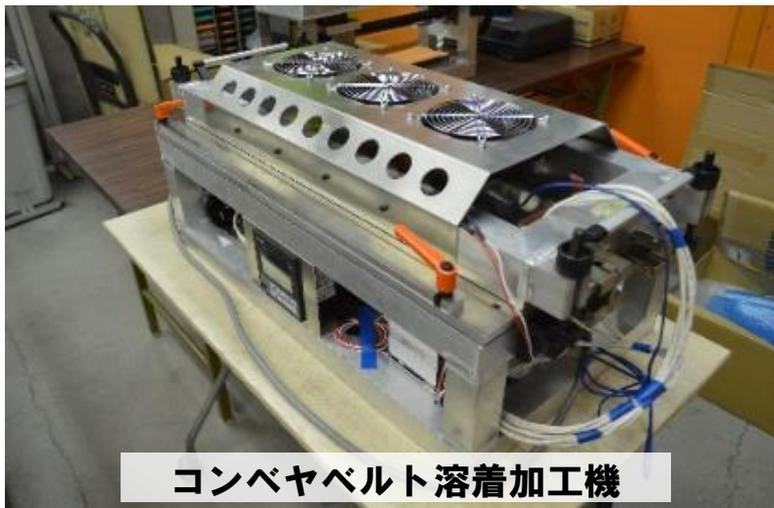
コンベヤベルト溶着加工機
